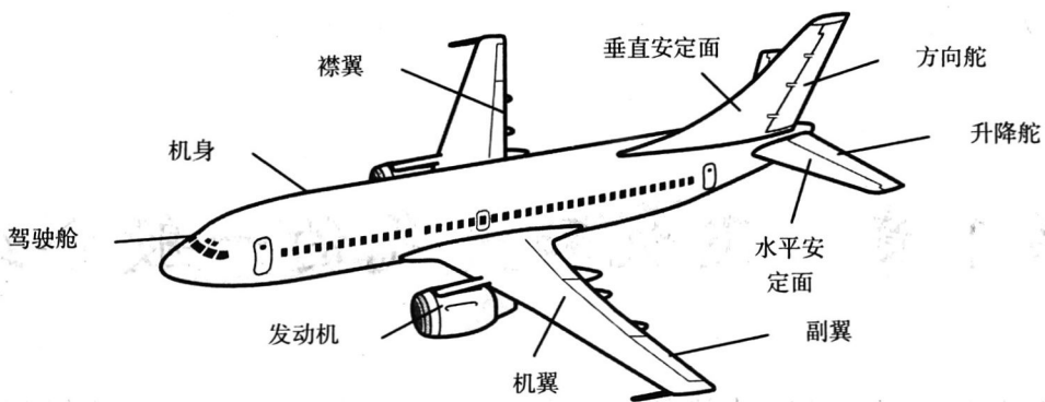
图 1.2 飞机的主要组成部分 (Boeing-737)
