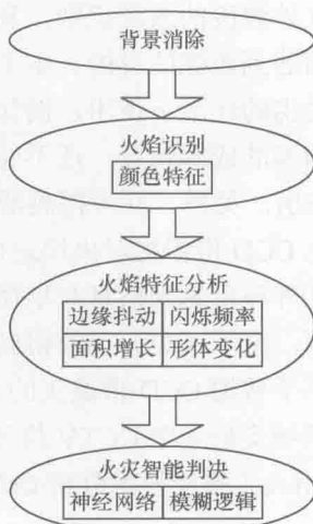
图 1.1 现有图像型火灾火焰探测算法的概念模型
