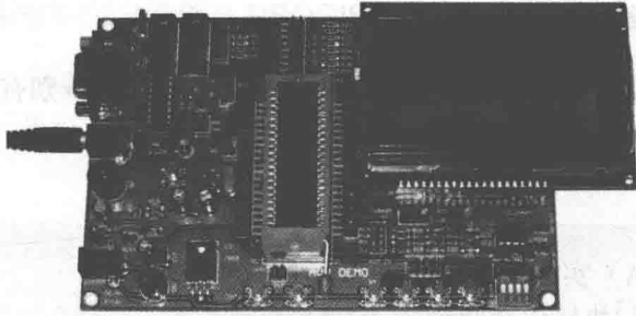
图 1-7 AVR DEMO 单片机综合试验板 (驱动 128×64 图形液晶)
