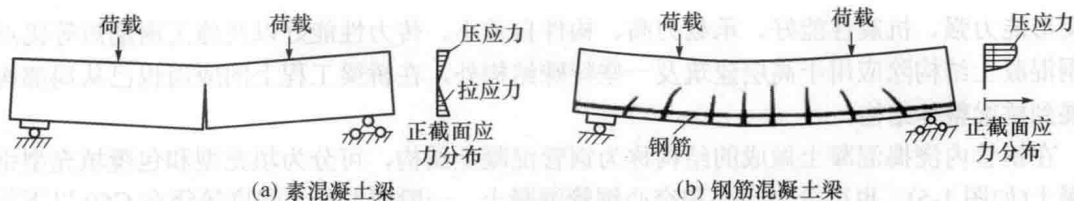
图 1-6 钢筋混凝土梁与素混凝土梁的比较
