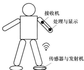
图 1-1 生物医疗电子系统的应用实例（无线运动鞋）
