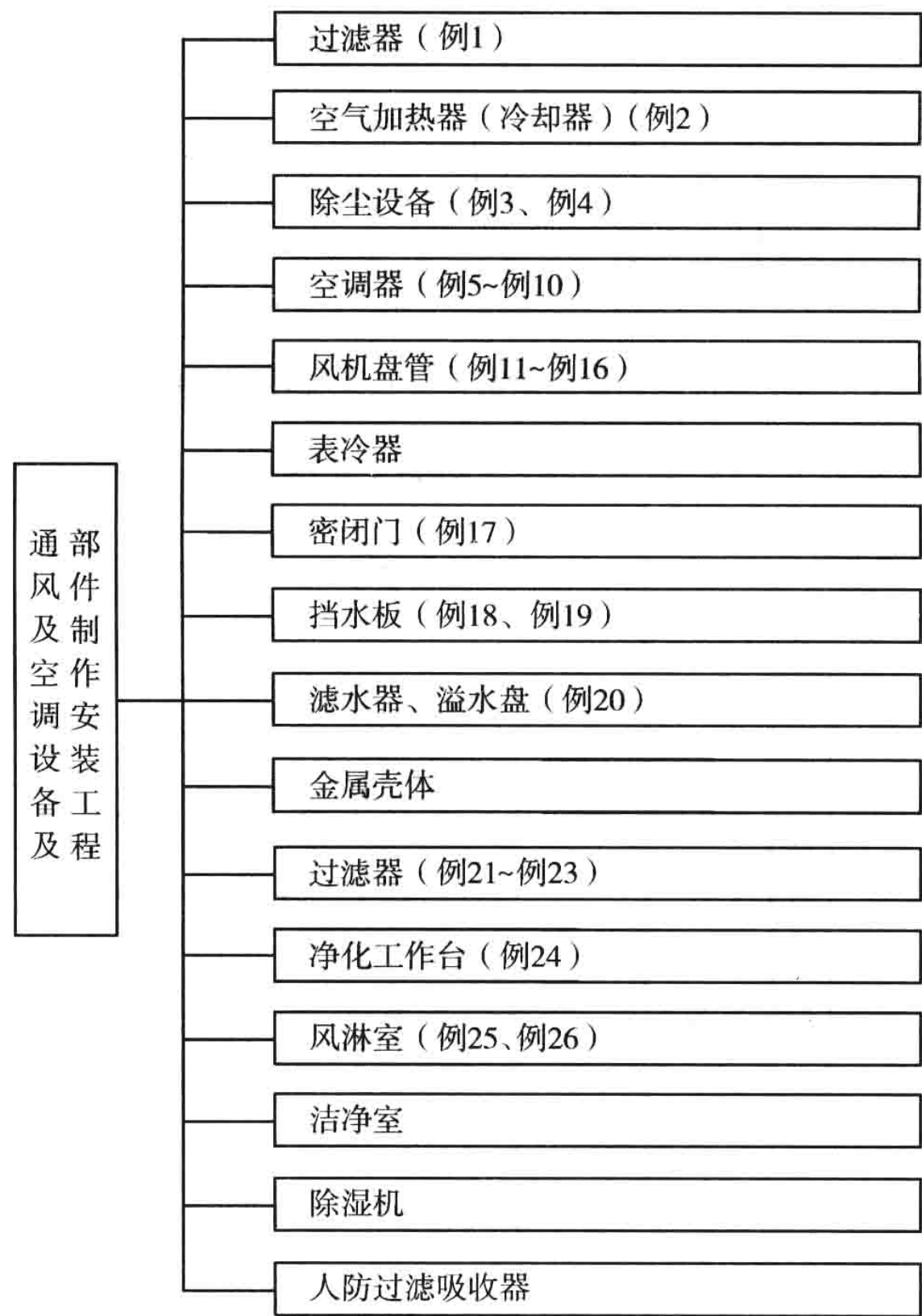
图 1-4 通风及空调设备及部件制作安装工程清单项目划分示意图
