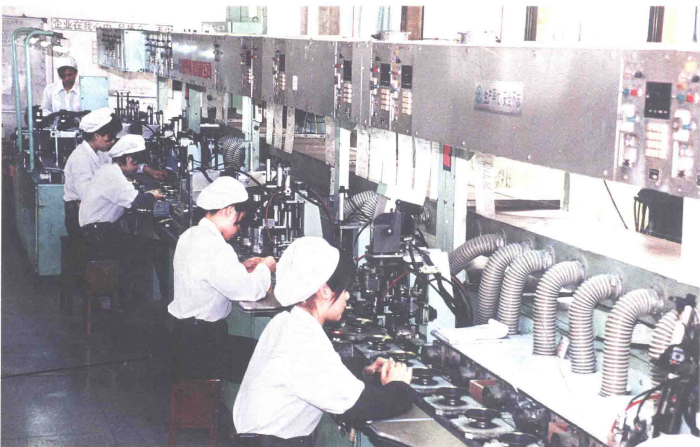
●1986年，广州国光电声总厂从日本引进的161扬声器半自动装配线
