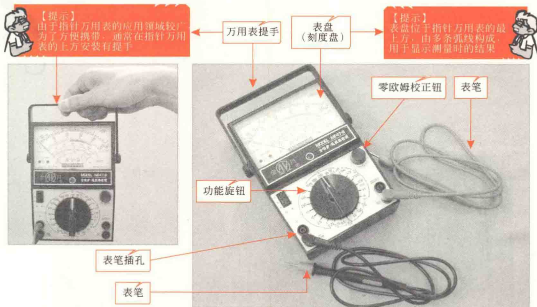
图 1-1 典型指针万用表的实物外形
