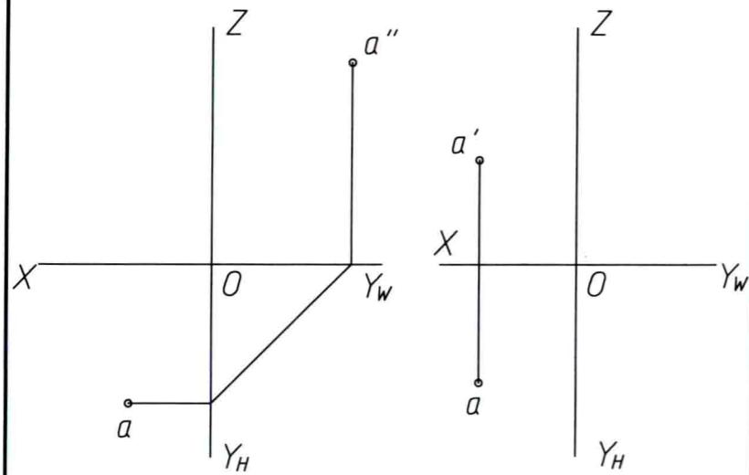
(2) 已知铅垂线DE的正面投影及端点E的侧面投影，画全它的侧面投影和水平投影。
