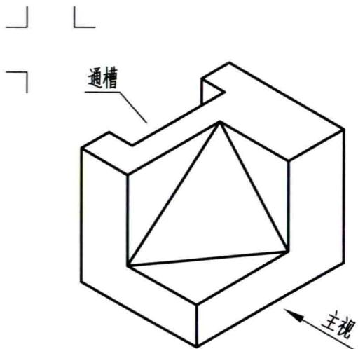
2.1 制图基本技能练习：在A3图纸上抄画（含尺寸），要求正确使用线型，粗细分明，尺寸注法正确。
