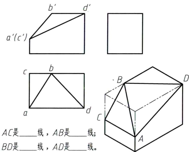
(4) 根据轴测图，在投影图中标出平面P、Q和R的三面投影，并填空。
