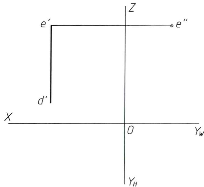
(3) 根据投影图判断下列各直线对投影面的相对位置，在左视图中画出各直线的侧面投影。
