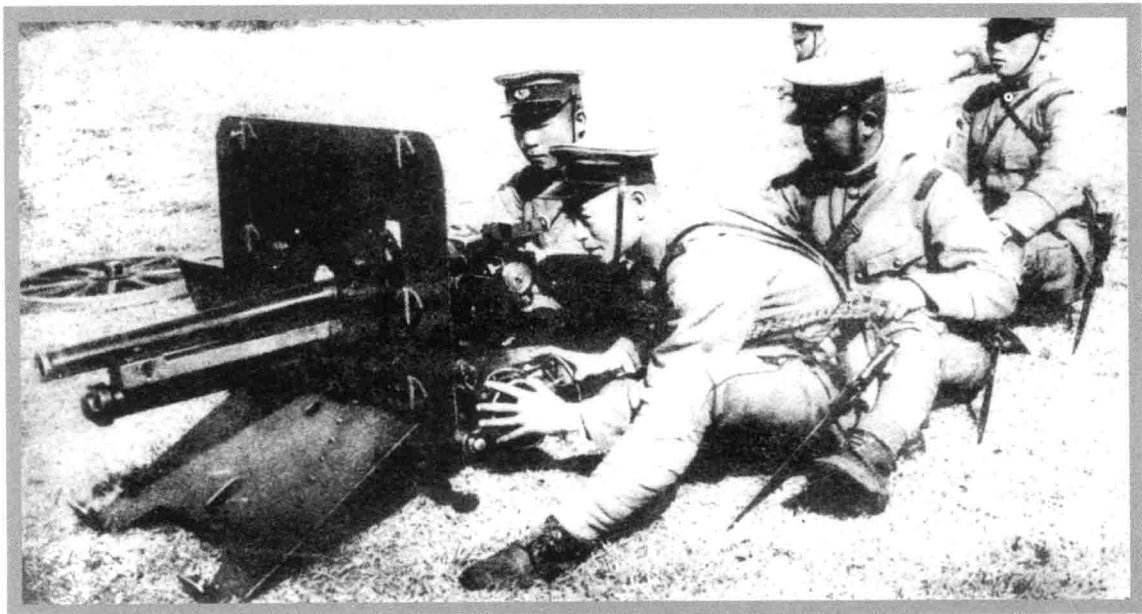
■ 日军士兵正在操作十一年式37毫米平射步兵炮进行射击训练，20世纪20年代引进后，日本以这款武器开始了反坦克的探索。
