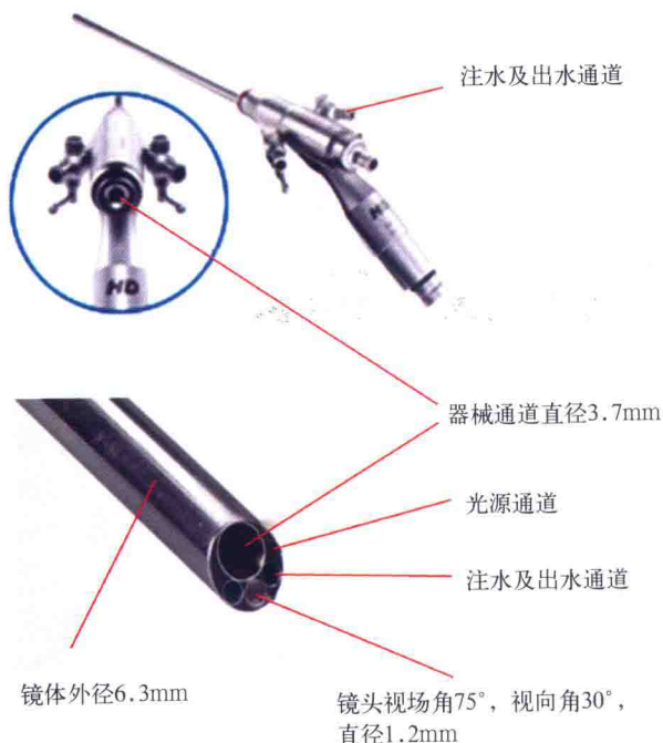
图 1-5 脊柱内镜具体构成及参数(经 Joinmax 公司惠允)
