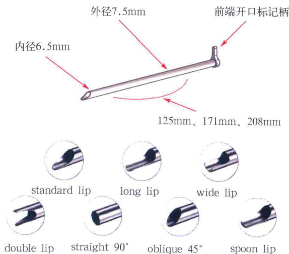
图 1-8 工作通道示意图(经 Joinmax 公司惠允)
