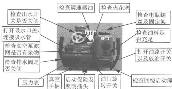
图 1-2 东发牌 VC20 泵结构示意图
