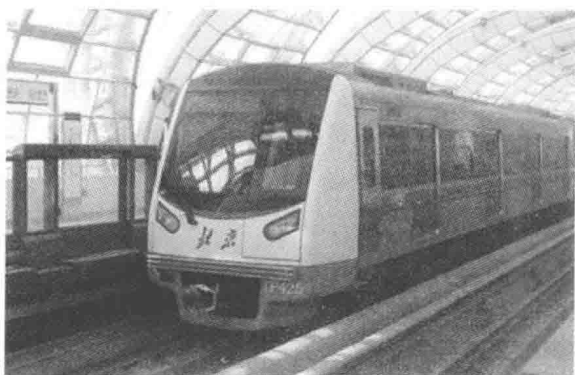
图 1-2 北京城市轨道交通不锈钢地铁车
