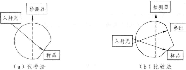
图 2-1 紫外漫反射法测量光路示意图
