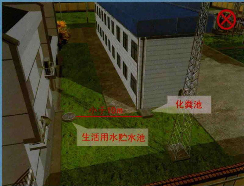
1.2 埋地式生活用水贮水池周围10m以内有化粪池。
