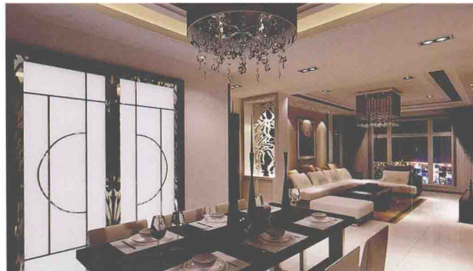
[ 石膏板吊顶 + 灯带 + 釉面砖 ]
