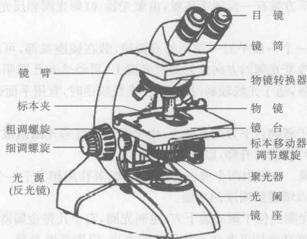
图 1-2 普通光学显微镜结构图
