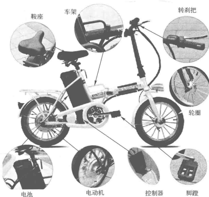
图 1-1 电动自行车整车构造示意图
