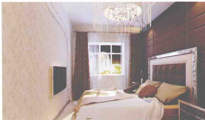
[ 软包床头墙面 + 石膏板造型吊顶 + 大芯板墙面造型 ]
