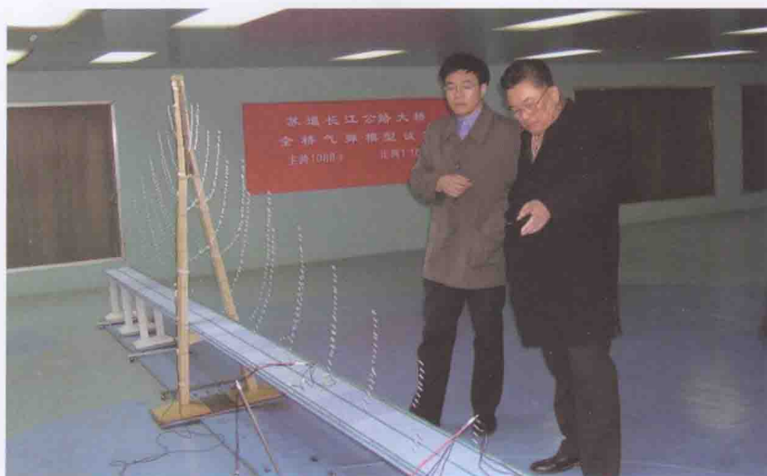
2004年，苏通大桥风洞试验
