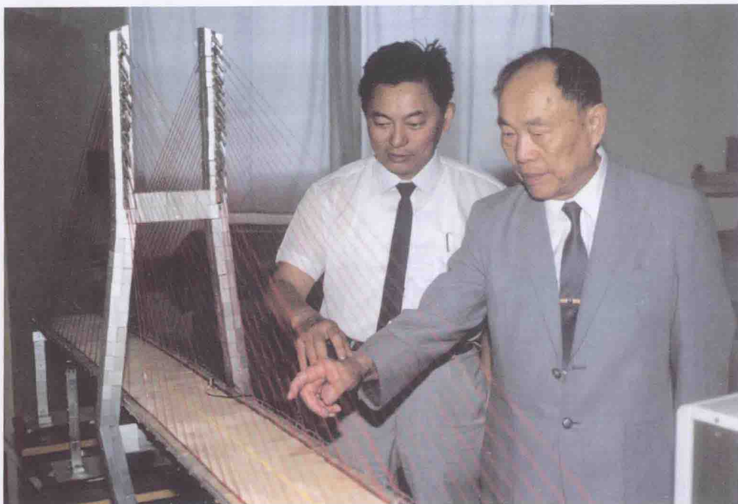
南浦大桥模型试验
