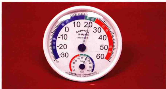
温湿度计 用途：用于测量温度、湿度。
