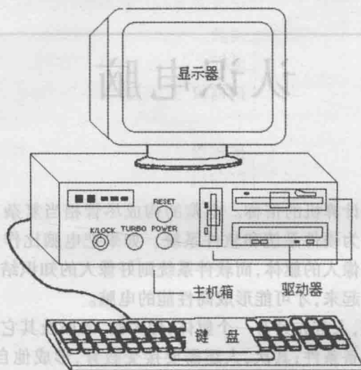
图 1-1 微型电脑的硬件系统
