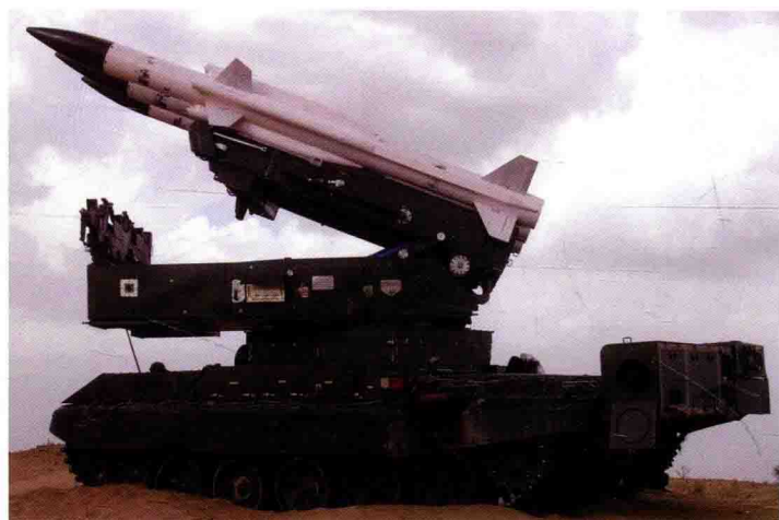
“阿卡什”导弹发射车（BMP-1 步兵战车底盘）
