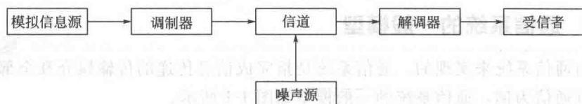
图 1-2 模拟通信系统模型
