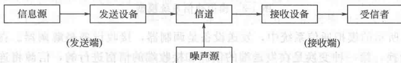
图 1-1 通信系统的一般模型
