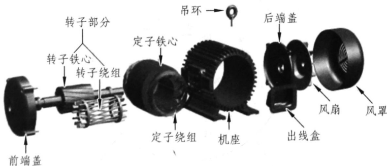
(b) 三相异步电机主要部件拆分图
