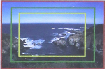
不同图像感应器取景范围的对比图 (红色：全画幅，绿色：APS-H，黄色：APS-C)
