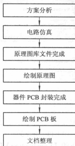
图 1-16 PCB 设计流程
