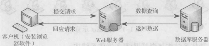
图 1-3 B/S 体系结构的应用系统运行过程
