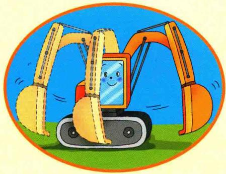
挖土机的身体可以自由旋转，因为驾驶座和履带轮子间有转盘。这样，挖土机不用走路，只需一转身就能将挖起的土倾倒在卡车上。
