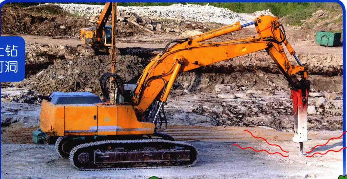
还有，挖土机的手臂换上不同的手，就可以做各种不同的工作。
