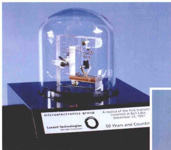
◀彩图 15 1947 年贝尔实验室发明的第一支基于锗的固态晶体管
