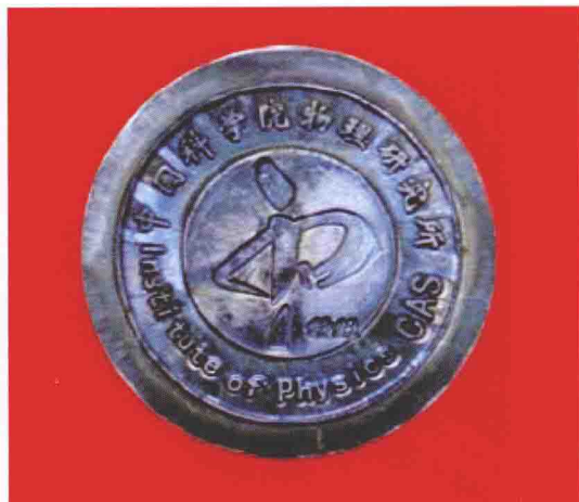
▲彩图 14 金属塑料在开水这种简单条件下压印的中国科学院物理研究所所徽图案
