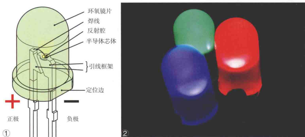
▲彩图 18 ①发光二极管的内部结构；②三种色彩的发光二极管
