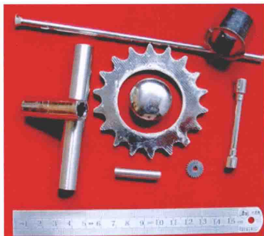
▲彩图 13 中国科学院物理研究所研制的大块金属玻璃的照片
