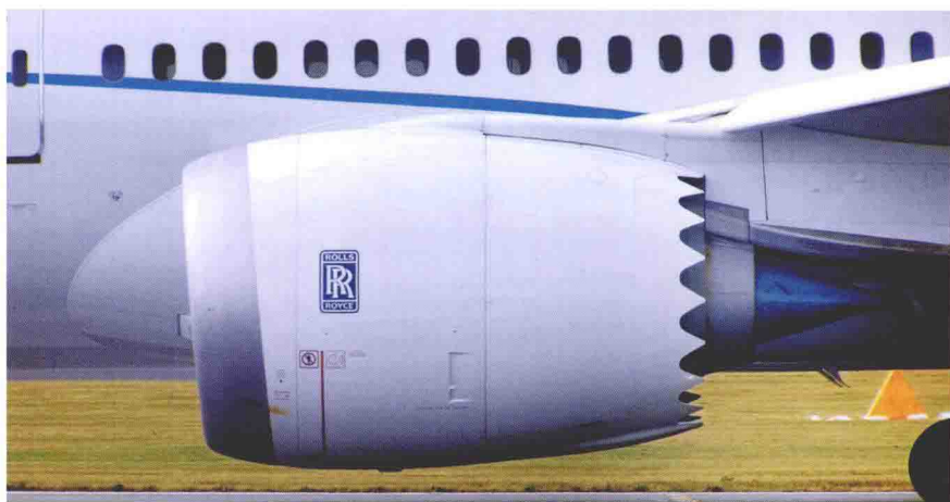
▲彩图 40 罗尔斯·罗伊斯公司生产的遑达 1000 型涡轮风扇发动机上的 V 形降噪结构
