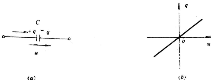
图 1-10 线性电容元件的图形符号及其库伏特性
