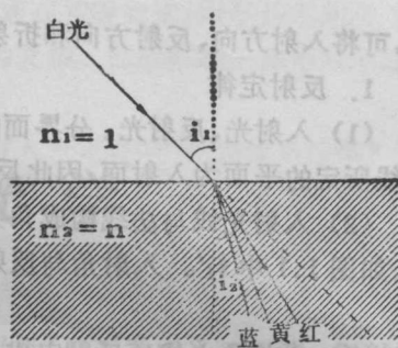
图 1.3 光在折射时出现色散现象
