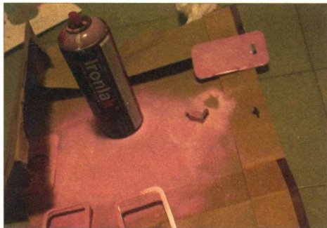
■ 图 1.3 用喷罐给相机外壳上色
