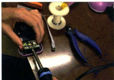
■ 图 1.8 把拍摄模块装入 LOMO 相机外壳内
