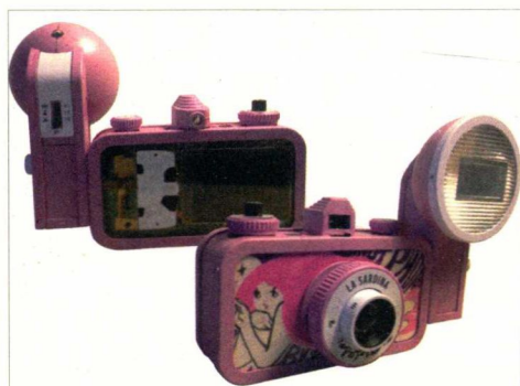
■ 图 1.9 大功告成！原来使用胶卷拍照的 La Sardina DIY 成功变身为数码相机
