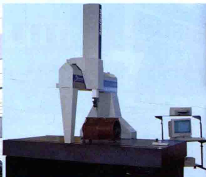
美国“Giddings Lewis”制造的三坐标(CNC)测量仪检测
