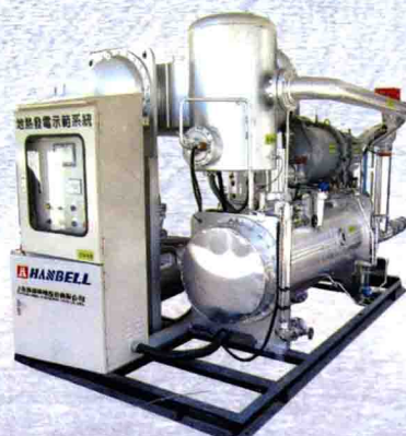
ORC 螺杆膨胀发电机
