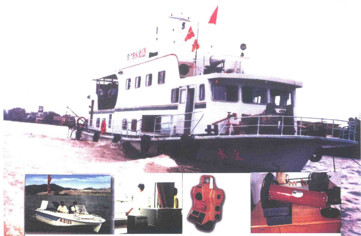
●1979—2000年，广东水文系统的水文测验设备有较大改善，大马力的铁质测船（大图）及快艇代替木质测船，同时引进先进的多普勒（ADCP）声学剖面测流仪、经纬测绘仪、全站测绘仪、绘图仪及一批现代化的测绘设备，使广东水文的测绘水平明显提高
