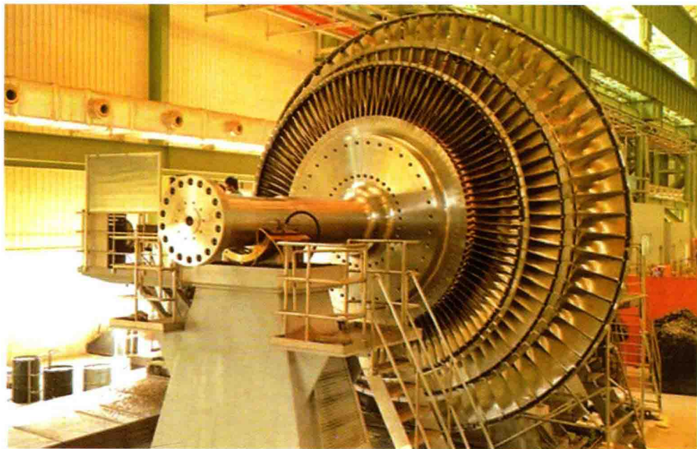
上海汽轮机厂开发的国内首个具有完全自主知识产权的大型核电汽轮超长 1710 毫米长叶片
