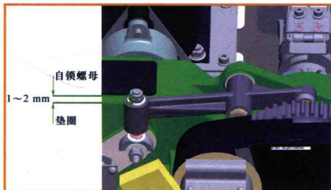
图 1-2 自锁螺母与垫圈间隙
