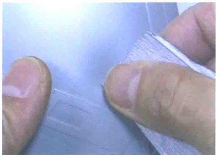
使用600号~800号的耐水砂纸进行处理。模型刀在切割表面时多少会留下伤痕，此时可以用砂纸打磨掉。
