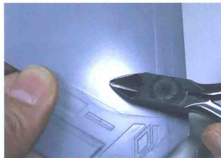
将斜口钳上刀刃平坦的一侧尽可能地贴紧机身的表面，然后将钉痕切除。
