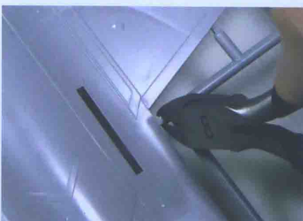
在剪下零件的时候，需使用刃尖较细且较锋利的斜口钳，剪切时注意留出少许水口。
