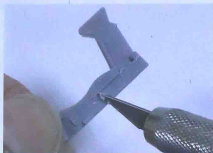
零件F13也是如此，将刀刃竖起来作为刨刀使用，将零件修整平坦。
