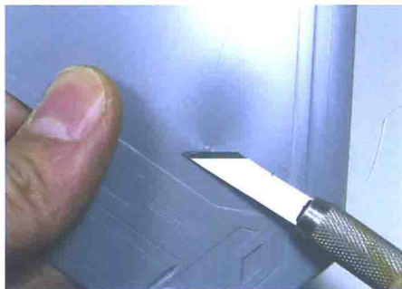
将刀刃贴紧机身表面，并把剩下的钉痕也削去。此时需要小心，不要损坏到表面。
