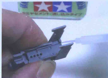
再次将零件拼合起来，确认没有留下缝隙之后，涂上流缝黏合剂进行固定。
