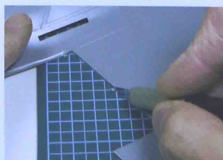
将剪下的零件放置切割垫上，用模型刀沿零件的形状将余下的水口部分切除。不要一次性切下，轻轻地分次进行切割，感觉就像在划线那样。
