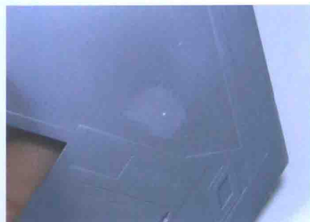
钉痕处理完成。之后使用更细的1000号~1200号耐水砂纸进行打磨，使它更加完善。
