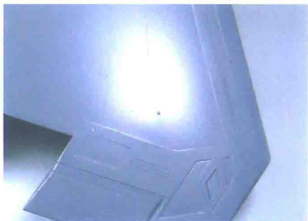
正如组装说明书中所提到的，零件A1上有6处板材成型时留下的钉痕，这些钉痕也需要切掉。
