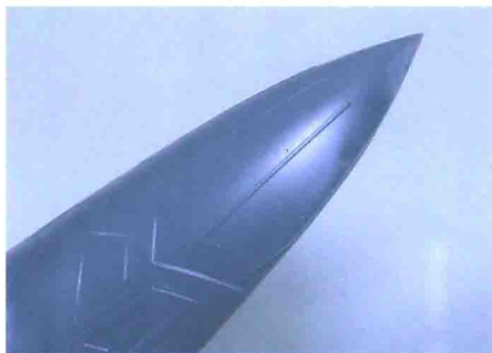
在不影响零件外形的情况下漂亮地完成了剪切。推荐在剪切后的部分用800号耐水砂纸进行打磨。
