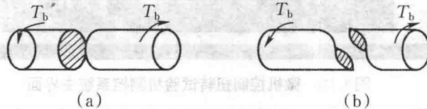
图 1.14 低碳钢和铸铁的扭转破坏断口形貌
