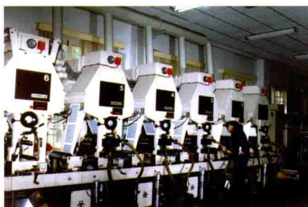
法国尚邦六色照相凹版轮转印刷机
