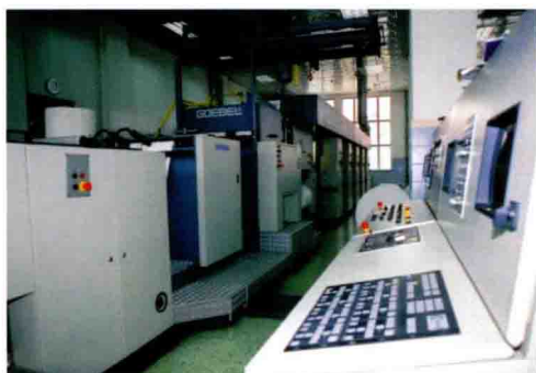
20 世纪 90 年代邮票印制局引进的德国格贝 尔五色照相凹版印刷机
