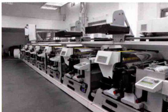
胶雕机胶版印刷单元采用了无轴传动技术
