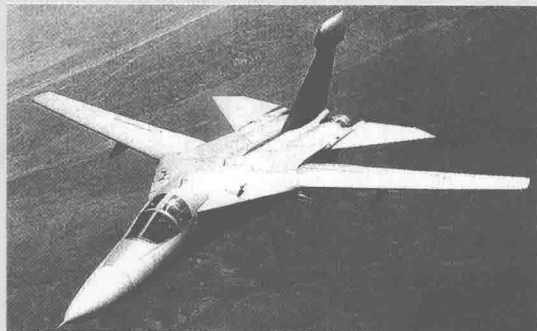
▲ EF-111A 电子战飞机能定向、半定向、全向辐射，全向辐射距离可达 230 千米
