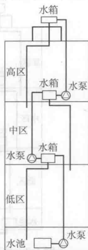
图 1-1 串联给水方式
