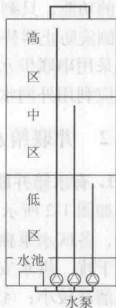
图 1-4 无水箱并联给水方式
