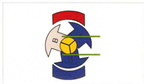
■ 图 2.2 换向器连接示意图
