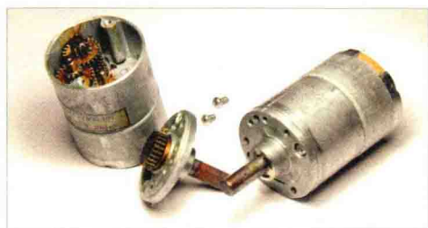
■ 图 2.4 多级金属直齿直流减速电机的拆解图
