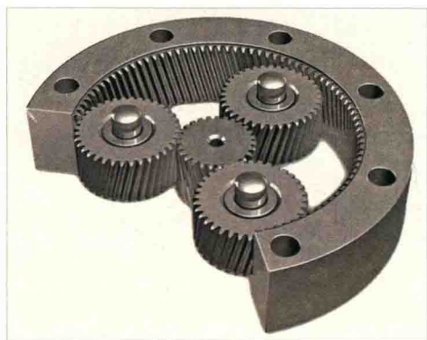
■ 图 2.3 典型的行星齿轮组结构
