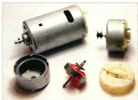
■ 图 2.1 拆开的有刷直流电机
