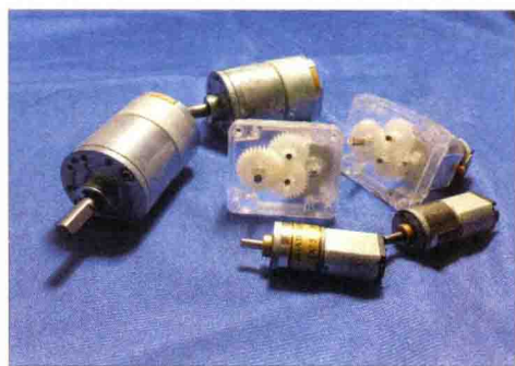
■ 图 2.5 塑料直齿减速电机和大小不一的金属直齿减速电机
