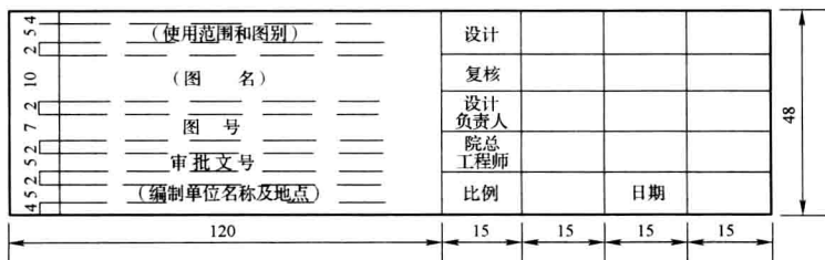
图 2.2.11—1 单张图纸图标格式(单位: mm)
