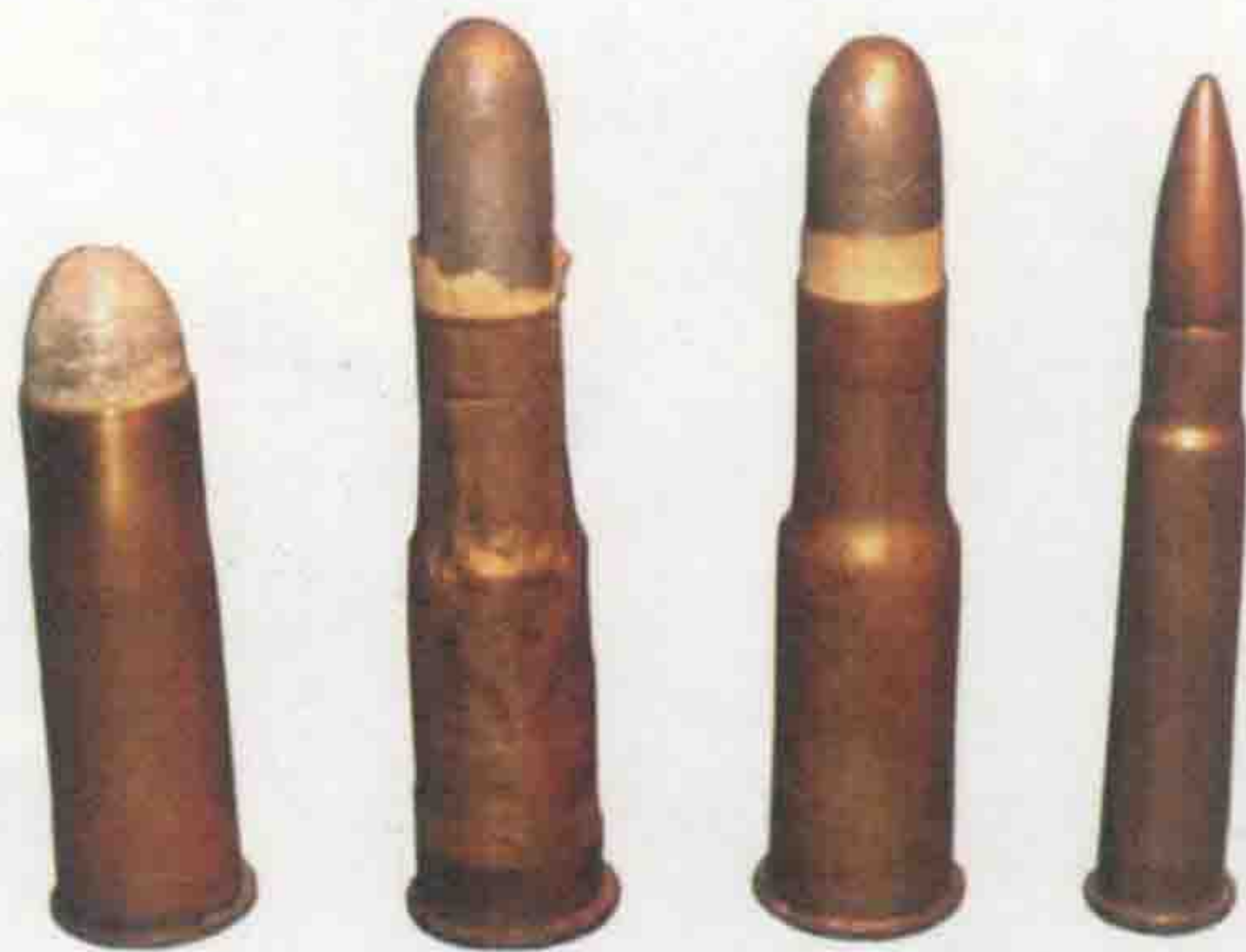
▲ 马蒂尼 - 亨利步枪使用的枪弹。从左至右，依次为 .557 英寸口径斯奈德弹、祖鲁战争时期使用的卷制薄黄铜皮 .557/450 英寸口径马蒂尼 - 亨利弹、祖鲁战争结束后使用的 .557/450 英寸口径马蒂尼 - 亨利弹、.303 英寸小口径弹。
