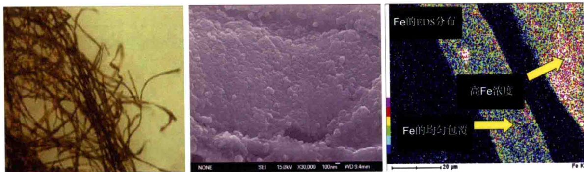
图7-6 四氧化三铁包覆的纤维素纤维的光学显微镜照片 (a)、扫描电镜照片 (b) 和铁元素分布图 (c)
