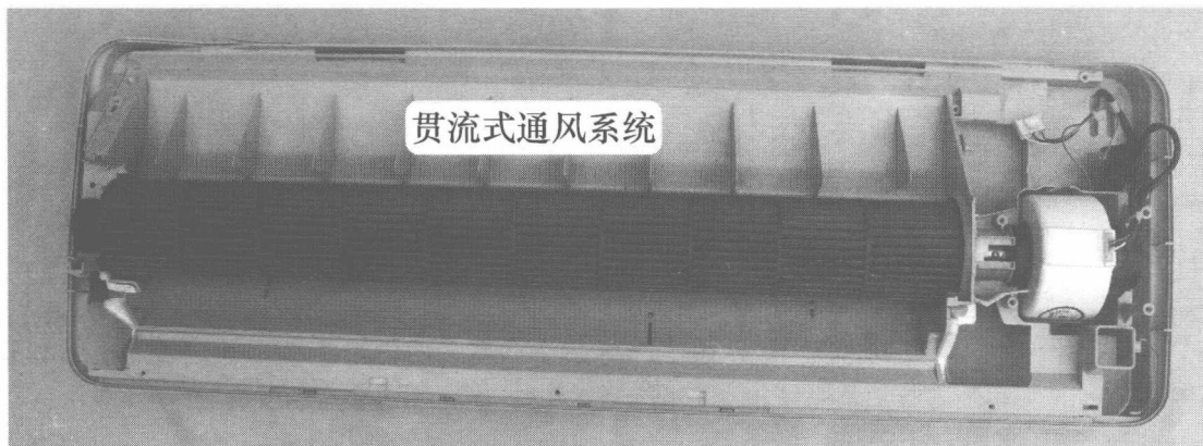
图 1-13 挂壁式空调器室内机通风系统
