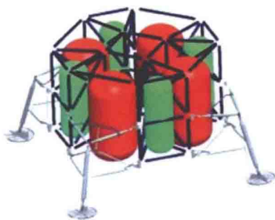
图 8.11 “牵牛星”登月车概念设计
