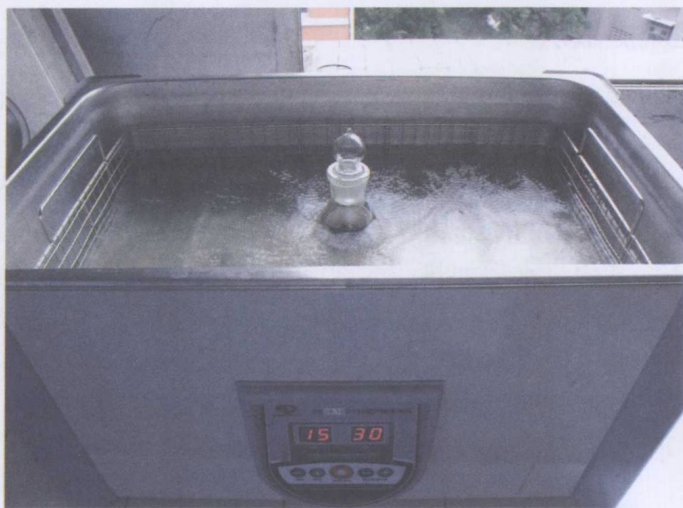
图1-9 超声提取法操作
