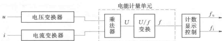
图 1.4 电子式电能表工作原理框图
